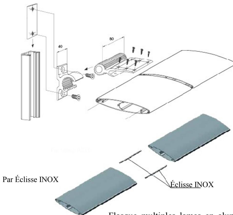
Flasque multiples lames en aluminium ou acier permettant un montage des lames en atelier ou sur site, constituant ainsi des panneaux et a poser. Les éléments peuvent être posés lames horizontales ou verticales
