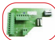
MOD-DCU MOD-FCU MOD-SC MOD-DC Carte électronique avec contacts de position et borniers débrochable.
